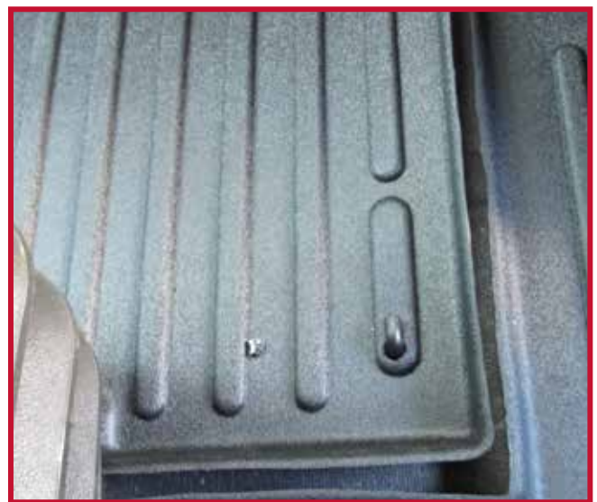
Figura 8 - Instalación del gancho del tapete del conductor
