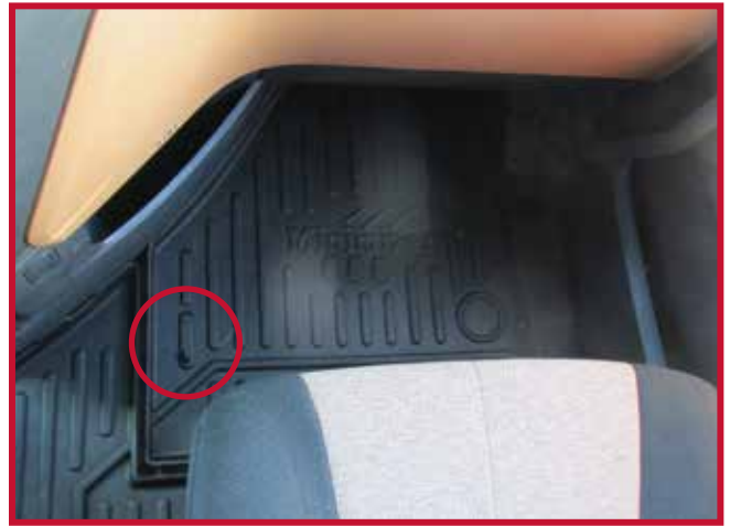
Figura 10 - Ubicación del gancho de retención del tapete del pasajero
