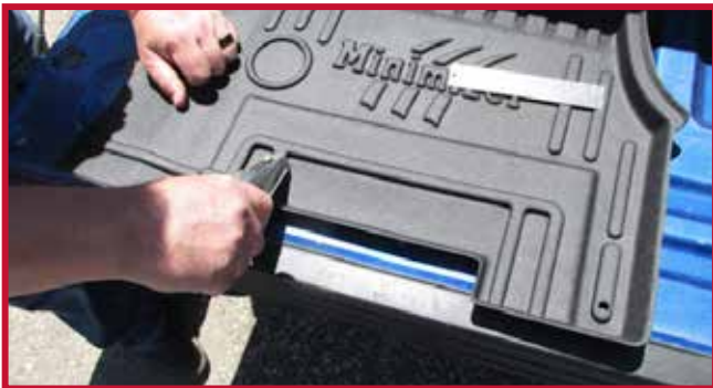
Figura 5 - Recorte manual del tapete del conductor para una posición de asiento personalizada
