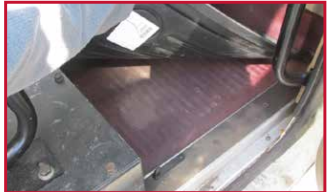
Figura 11 - Gancho del tapete del pasajero en posición
