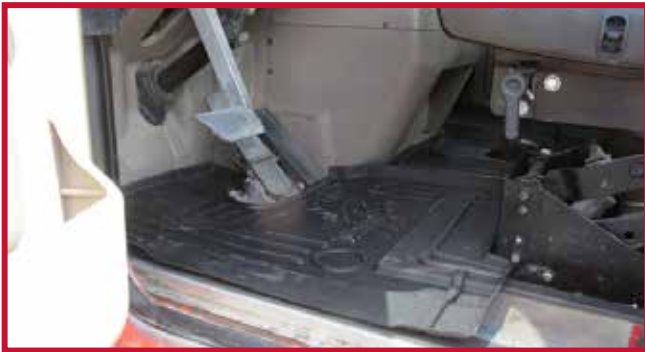
Figura 5 - Recorte manual del tapete del conductor para una posición de asiento personalizada
