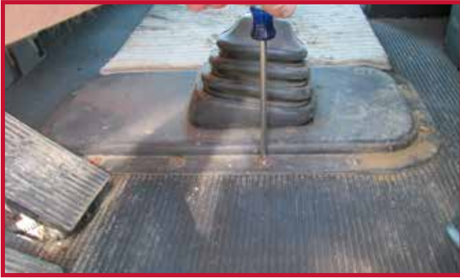
Figura 6 - Extracción del tornillo
