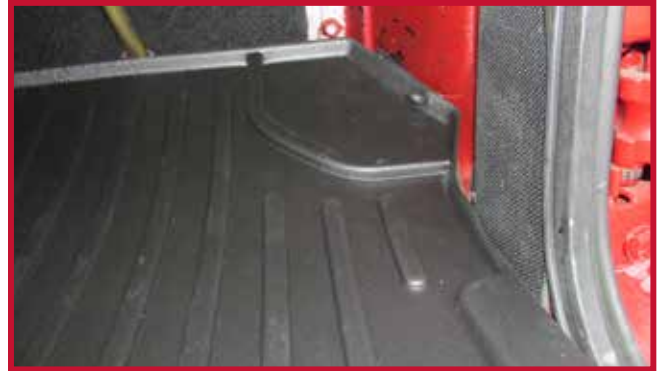
Figura 14 - Asiento del pasajero de base fija con tapete recortado
