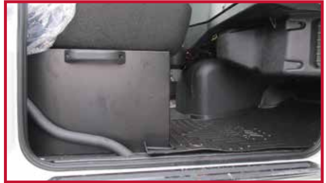
Figura 14 - Asiento del pasajero de base fija con tapete recortado
