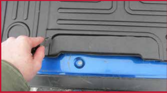
Figura 7 - Diagrama de recorte del tapete del conductor
