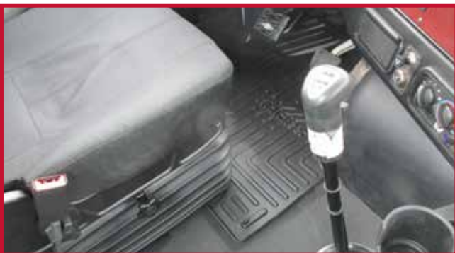
Figura 9 - Gancho del tapete del conductor en posición
