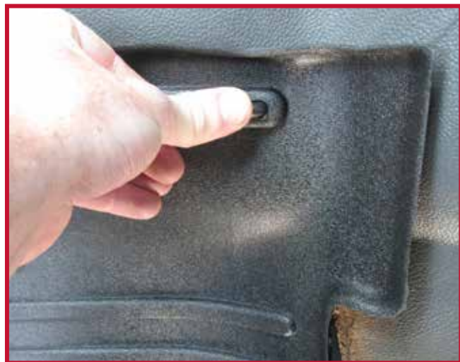
Figure 8 – Appliquer une pression sur le crochet
