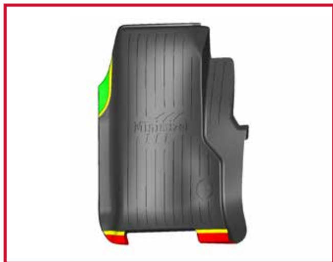
Figure 9 – Schéma de découpage du tapis côté passager
