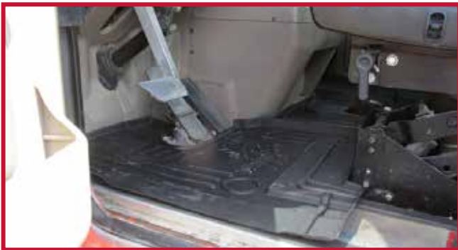
Figure 5 – Découpage à la main du tapis côté conducteur pour un positionnement personnalisé adapté au siège
