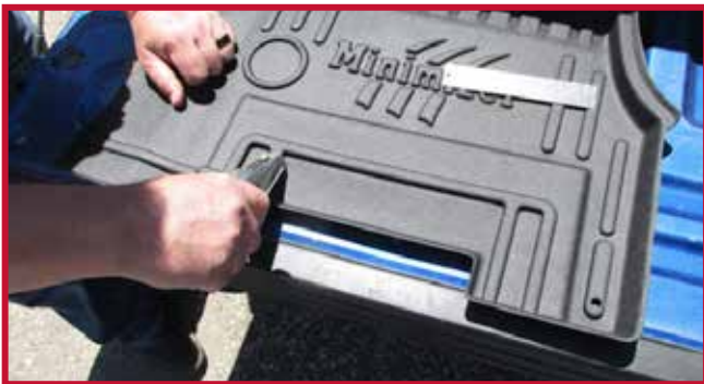
Figure 5 – Découpage à la main du tapis côté conducteur pour un positionnement personnalisé adapté au siège
