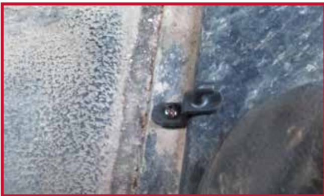
Figure 7 – Orientation appropriée du crochet
