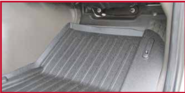
Figure 12 – Tapis côté conducteur et crochet correctement installés
