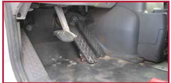
Figure 6 – Pédales d'accélérateur et de frein montées au plancher
