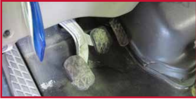
Figure 2 – Pédales d'accélérateur et de frein suspendues
