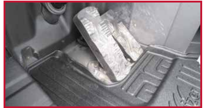
Figure 3 – Contact du tapis côté conducteur avec le panneau inférieur
